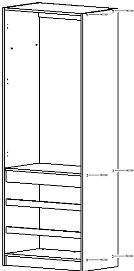
12. У чверть (виїмку) деталей 20.16.13 і 20.16.14 встав задню стінку з ДВП, використай на стику з'єднуючий профіль. Зафіксуй цвяхами.
