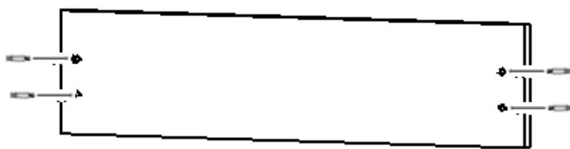
20. З'єднай деталь 20.16.07 з конструкцією, закруті ексцентрики мініфіксів.
